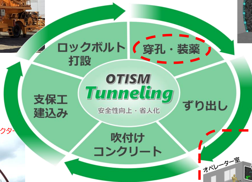
発破孔の高精度自動削孔
